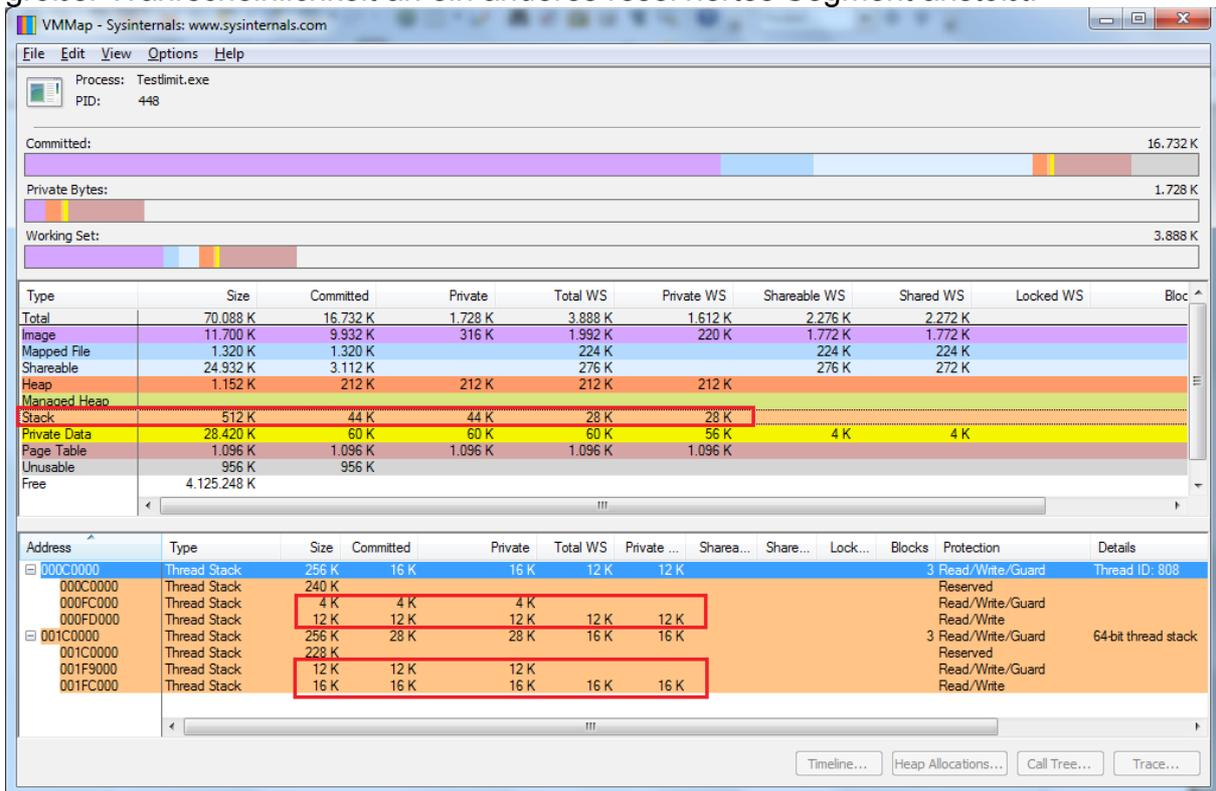
Das obige Bild zeigt zwei Stack-Segmente mit je 256 KB Größe: eines für 32-bit und eines für 64-bit (der Kernel ist ja 64-bit und Systemcalls benötigen eine 64-bit-Stack). Von den 512 KB sind 44KB zugesagt, letztlich aber nur 28KB im aktiven WorkingSet (siehe unten). Die Guard Page liegt zwischen aktivem Stack und reserviertem Stack und sorgt für die dynamische Erweiterung des Stacks.
